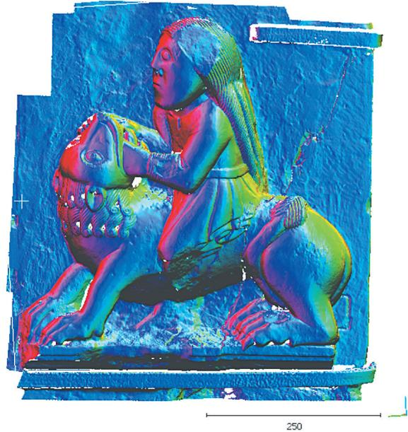
Fig. 4. Modello 3D della scultura angolare della Torre Civica danneggiata dal sisma del 2012. La particolare colorazione in funzione delle direzioni normali alle superfici rilevate permette di individuare agevolmente la linea di fratturazione diagonale (© UniMORE - GEIS).
