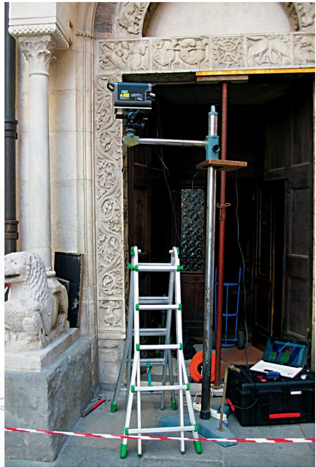
Fig. 1. Fase del rilevamento 3D ad altissima risoluzione dei bassorilievi della Porta della Pescheria del Duomo di Modena. Il laser scanner a triangolazione Range7 di Konica Minolta assicura un'accuratezza di digitalizzazione pari 0.04 mm (© UniMORE - GEIS).
