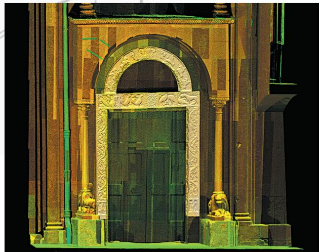
Fig. 2. Modello 3D a nuvola di punti (risoluzione media 3 mm) della struttura della Porta della Pescheria del Duomo di Modena a cui è sovrapposto il modello 3D a mesh dei bassorilievi (risoluzione media 0.3 mm) (© UniMORE - GEIS).
